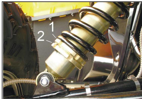
1. Регулировочная гайка жесткости пружины.
