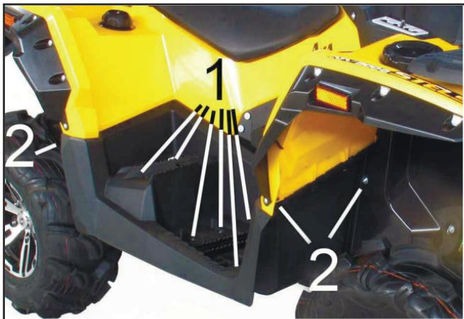
1. Винты крепления опоры для ног к металлическому каркасу.
