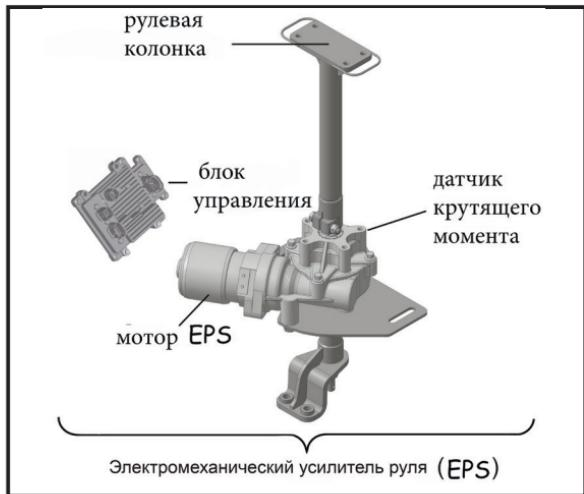
**ПРЕДОСТЕРЕЖЕНИЕ:** Для предотвращения случайного повреждения устройства - не разбирайте блок электромеханического усилителя руля.
