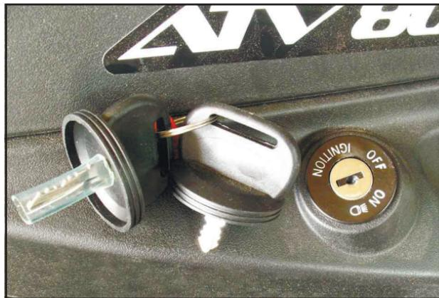
«**OFF**» - двигатель и освещение не работает, все электроприборы выключены. Ключ можно вынуть. Для выключения двигателя установите ключ в это положение.
