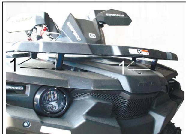
1. Винты крепления стоек каркаса багажника.
