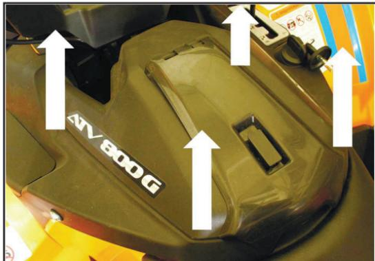
1. Снимите корпус бардача.
